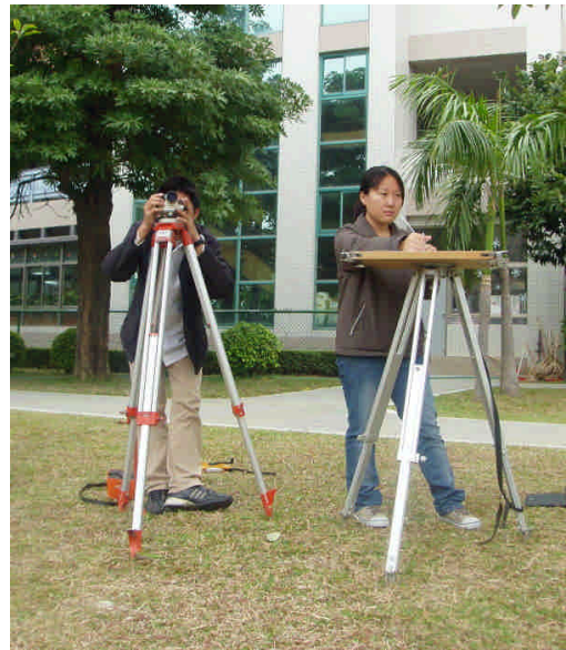
圖 2-8-1 水準儀配合平板儀測繪法
