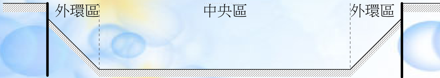
(三) 施築中央區結構體
